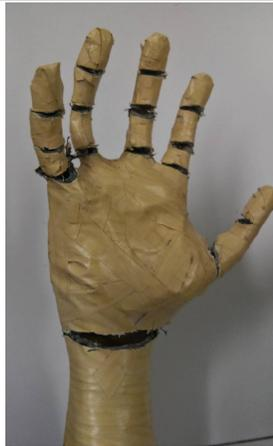
CORTES NAS JUNÇÕES DOS DEDOS E DO PUNHO. FIBRA DE VIDRO REVESTIDA COM LINHA E TIRAS DE CONTACT. MÉTODO DESENVOLVIDO PARA A JUNÇÃO DAS DUAS PARTES DA MÃO EM FIBRA DE VIDRO.
